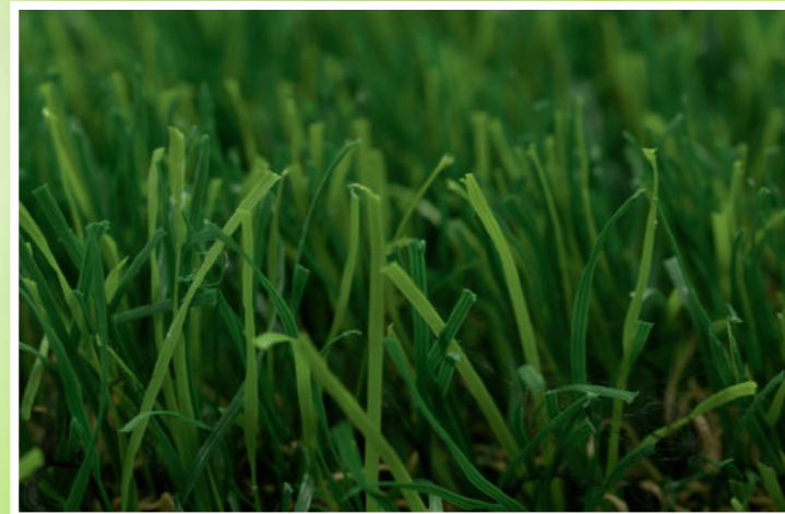
Kunststofffasern auf Polypropylen-Gewebe
