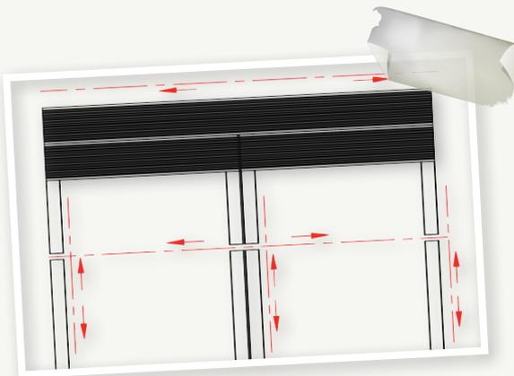
Die WPC Dielen dürfen nur auf einem soliden – am besten betonierten – Untergrund verlegt werden. Es darf sich kein Wasser unter dem Boden bilden – **Regenwasser muss abfließen** können (z. B. entsprechend der Pfeile in der Skizze) und entsprechende Luftzirkulation muss gegeben sein.
