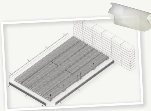
Die WPC Abschlussprofilwinkel aus resistentem Alu verdecken die Unterkonstruktion und Ihr neuer WPC Boden erhält dadurch den letzten Schliff.
