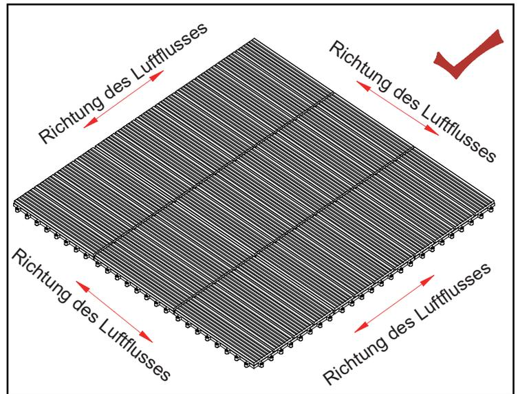
2. Die Holzfliesen sollten in einem System verlegt werden, ebenso sollte auf eine ausreichende Luftzirkulation geachtet werden. Feuchtigkeit aus dem Boden kann die Stabilität der Fliesen beeinträchtigen.
